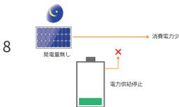
放電停止中です。夜間などで太陽光発電電力がなく、蓄電池に十分な電力量がない（運転モードで設定された最小容量以下）場合に、システムは蓄電池の消耗を極限まで減らす運転に切り替わります。太陽光発電が多くなる場合や充電開始時間になった際は、通常運転に切り替わります。
