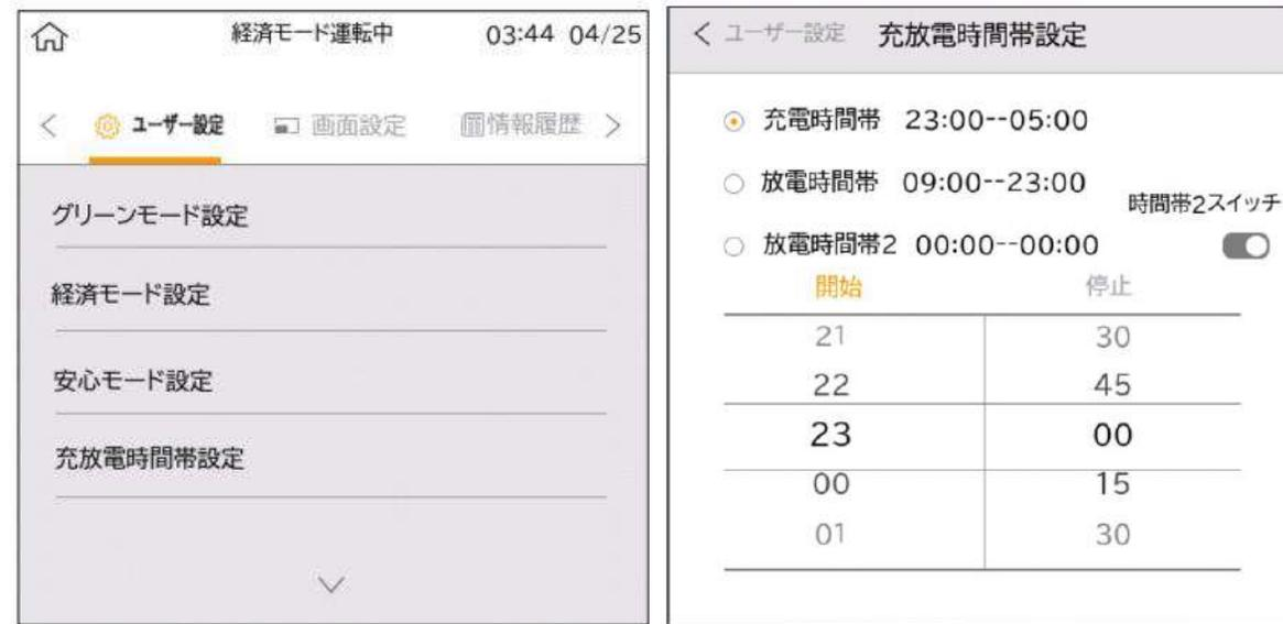
充電時間帯の設定で、蓄電システムは設定された時間帯に入りますと、系統から買電して充電します。
